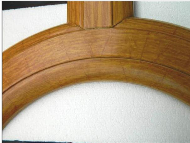
Wie Sie im oberen Bild erkennen können (Rahmen in Eiche Natur) sind in den Radien dunklere Striche zu erkennen. Diese dunkleren Verfärbungen sind produktionstechnisch bedingt. Da hier im Anschluss an die Grundbeschichtung eine Folie mit dem Farbpigment (mit speziellen Pigmentfolien) auf den Rahmen gesaugt bzw. geklebt wird, bilden sich hier kleinere Falten (nur in den Radien), die nicht zu verhindern sind.
