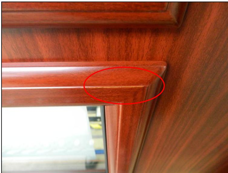
Kantenflucht ist ein physikalischer Effekt, der bei der Beschichtung von Oberflächen auftritt und dazu führt, dass die Beschichtung an Kanten dünner ausfällt als auf ebenen Flächen. Durch die Grundbeschichtung, die bei diesem speziellen Beschichtungsverfahren angewandt wird, kann es nur sein, dass es bei der „Holzmaserung“ zu einer Kantenflucht kommt.
