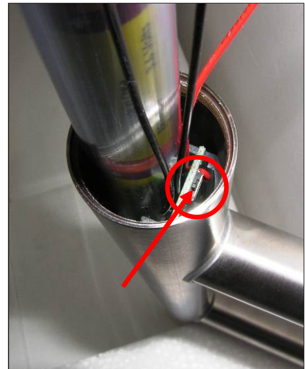
Das schwarze Kabel wird nicht eingeklemmt, wenn es zur Tür hin liegt!
