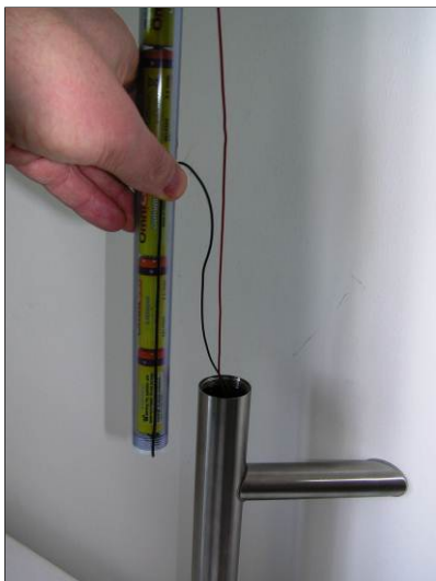
Halten Sie das schwarze Kabel beim Einlegen straff!
